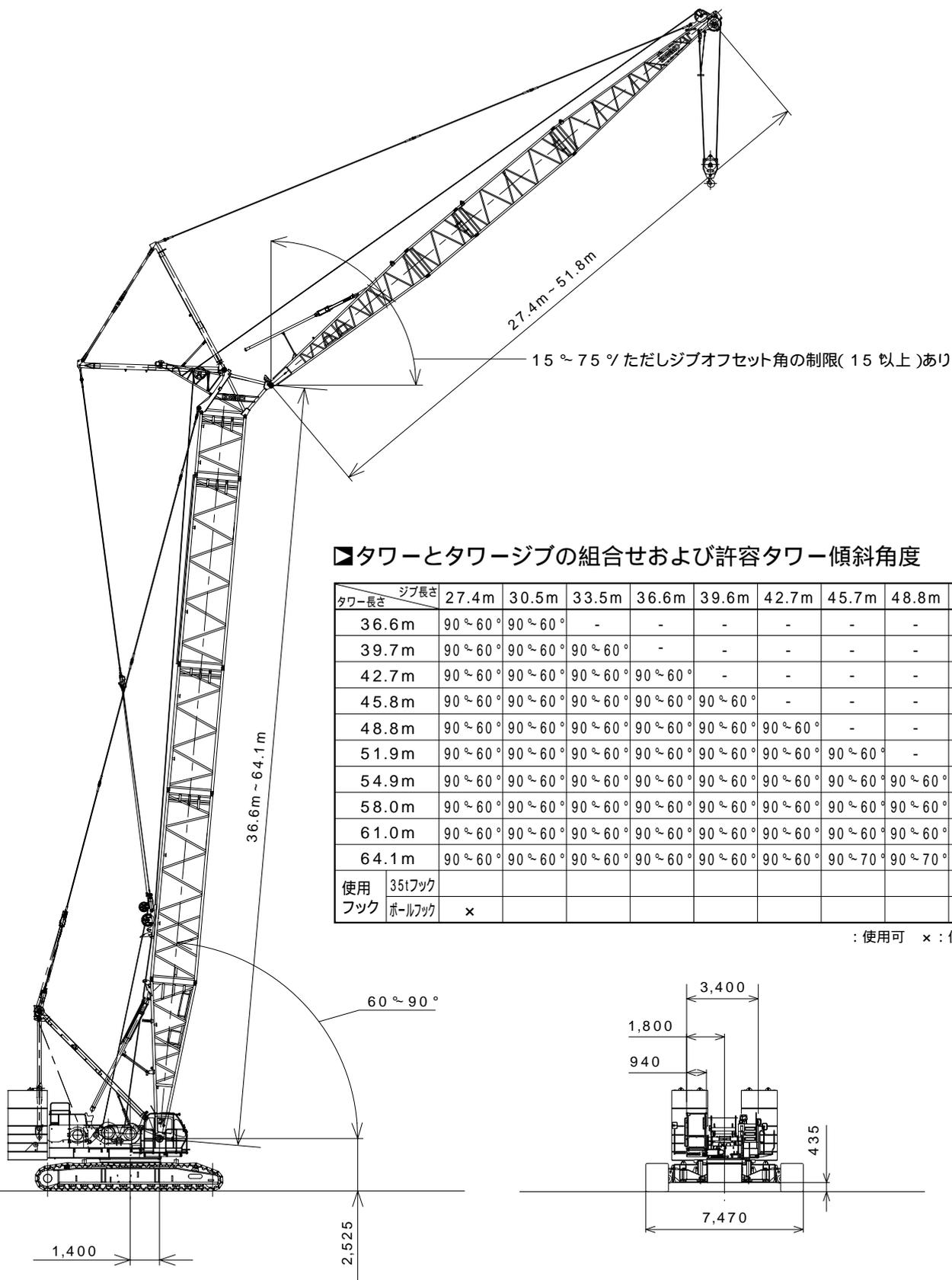
▶タワーとタワージブの組合せおよび許容タワー傾斜角度
